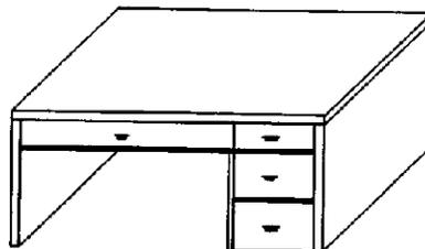
Figura 2.13: Desenho em Três Dimensões Apresentado com a Perspectiva de Cavaleira [13].
